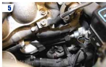
5 Une fois le carter vide (l'huile s'écoule goutte à goutte), dévisser le filtre à huile à l'aide d'un outil spécial. S'il résiste, le percer de part en part avec un tournevis pour le desserrer. Manipuler le filtre de manière à ne pas faire couler l'huile.
