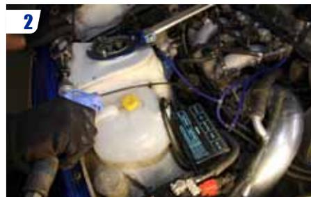
2 Bien nettoyer la zone autour du filtre à huile à l'aide de nettoyant frein. Si possible, souffler avec un compresseur. L'environnement et l'accès au filtre doivent être propres.
