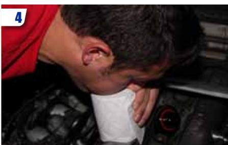
4 Petite astuce : pour vidanger un maximum d'huile, coller un tube d'essuie-tout ou de papier toilette sur l'orifice de remplissage et souffler dans le moteur afin d'expulser encore un peu de lubrifiant.
