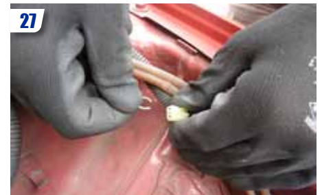
27 Une fois l'échangeur retiré, refermez les deux coques et boucher l'orifice jusqu'alors dédié au passage des tuyaux à l'aide de scotch résistant.
