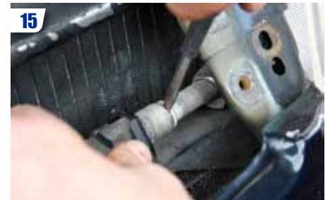
15 Déconnecter l'ensemble durites du circuit de clim : sur le compresseur (pièce entraînée par le moteur), sur le condenseur (petit réservoir en alu) et au niveau du tablier.
