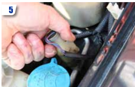
5 Débrancher la grosse cosse connectée à la durite haute pression du circuit, ainsi que celle au ventilateur de clim (celui situé à droite lorsque vous faites face à l'auto).
