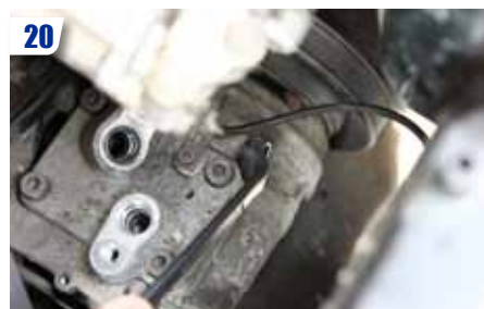
20 Dévisser le compresseur de son support (4 vis) et le déposer. Nota : si votre auto est équipée d'une D.A., il faudra dévisser la pompe et l'écarter pour sortir le compresseur. Attention, du liquide peut couler du compresseur ! Installer ce dernier dans une bassine.
