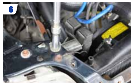
6 Démontez les points d'ancrage des relais et des supports de câbles afin de pouvoir écarter le faisceau électrique de la clim.
