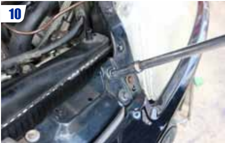
10 Dévisser les 4 vis de la traverse supérieure.
