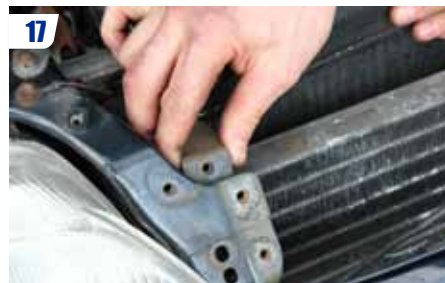
17 Dévisser les supports du radiateur de clim.
