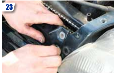
23 Installez la traverse supérieure en n'oubliant pas de remettre en place le câble d'ouverture capot (manipuler avec précautions).
