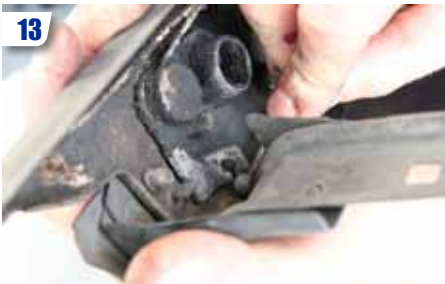
13 Retirer l'extrémité du câble et déposer la traverse.
