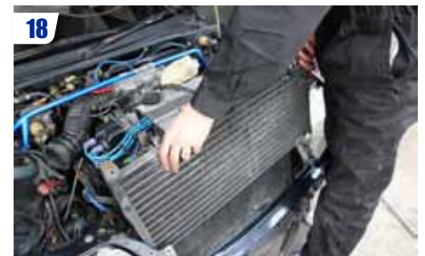
18 Repousser le radiateur moteur vers l'arrière et retirer le radiateur de clim. Les versions françaises n'ayant pas de direction assistée, cette opération se passe sans encombre.
