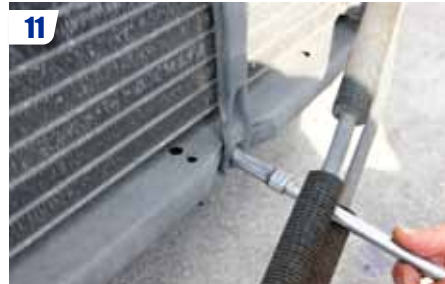
11 Retirer la vis située à la base du renfort vertical. Nota : vous pouvez écarter le refroidisseur de liquide de direction assistée pour faciliter l'accès à cette vis.
