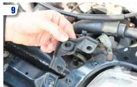
9 Déposer les deux pattes supérieures de fixation du ventilateur moteur.
