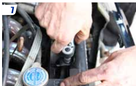
7 Dévisser les points d'ancrage supérieurs du ventilateur de clim.
