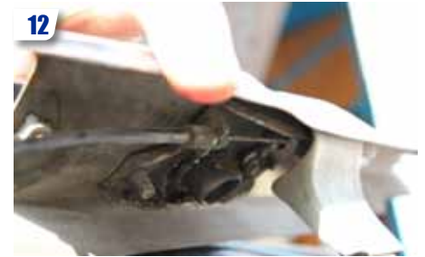
12 Soulever la traverse pour avoir accès au câble d'ouverture du capot. Déclipser la butée verte. Attention, celle-ci est fragile.
