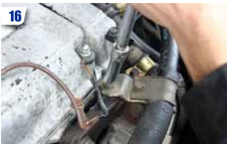
16 Démontez les supports des durites et déposez ces dernières. Nota : il faudra écarter le réservoir de D.A. sur les autos équipées de la direction assistée.
