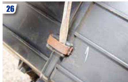
26 Retirez les clips et les vis qui maintiennent les deux coques du bloc afin de retirer l'échangeur thermique.
