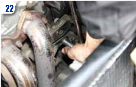
22 Démontez le support du compresseur de clim.
