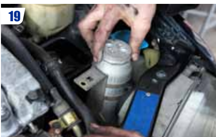
19 Déposer le déshydrateur.
