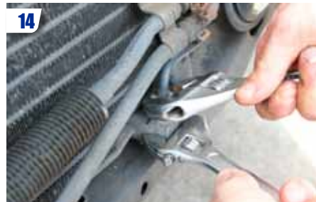
14 Déconnecter les durites du circuit de clim du radiateur. Attention, les zones de fixation en alu sont fragiles : les maintenir avec une seconde clef afin de ne pas les endommager.
