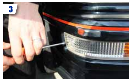
3 Démontez les clignotants pour avoir accès aux vis du pare-chocs.
