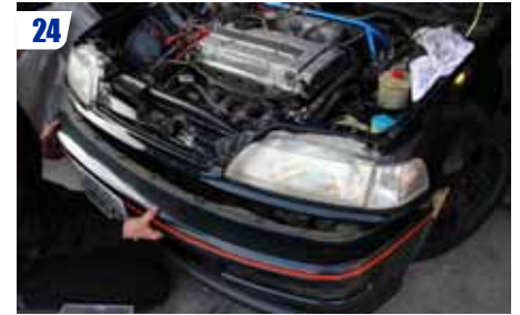
24 Installez le pare-chocs et les clignotants.
