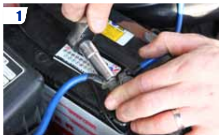
1 Débrancher la cosse négative de la batterie.
