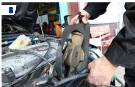
8 Déposer le ventilateur de clim.
