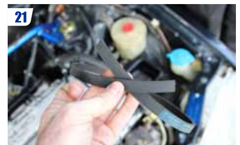
21 Sur les versions D.A., pour gagner du temps, vous pouvez couper la courroie de compresseur. Nota : si vous souhaitez la conserver, il vous faudra démonter celle de direction assistée auparavant. (Nous ne sommes pas fiers d'avoir voté pour le dépeçage façon vautour pour cette étape.)
