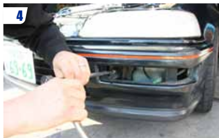
4 Déposer le pare-chocs (2 vis au niveau de chaque passage de roue et 4 vis derrière les clignotants). Attention de ne pas abîmer la carrosserie en retirant le pare-chocs. Se faire aider d'une personne si possible.
