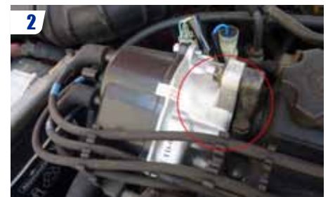
2 Pour être sûr de votre modèle avant de commander un neuf ou trouver un d'occasion, vous trouverez la référence gravée à cet endroit (ici un TD-03U).
