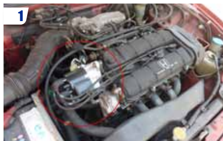
1 Localisez l'allumeur. C'est la pièce entourée en rouge.
