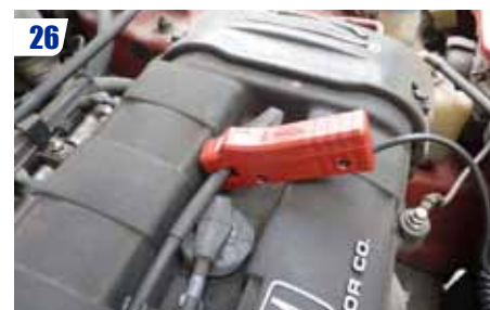
Connectez ensuite la lampe au fil de bougie n°1 (côté distribution), la flèche doit pointer vers la bougie.
