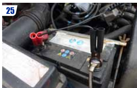
Connectez la lampe stroboscopique à la batterie.
