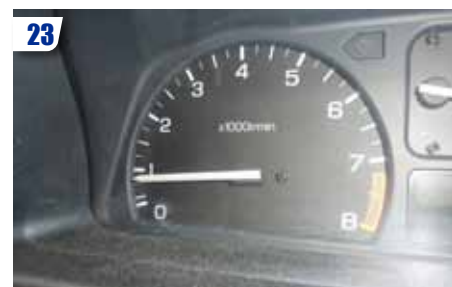
Redémarrez le moteur. Vérifiez le régime au ralenti. Pour ED7, il doit être à 800tr/min +/-50 moteur chaud.
