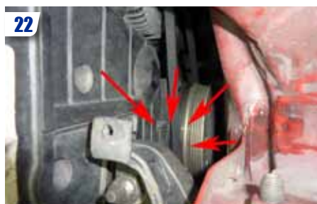
Localisez les repères sur le cache distribution et la poulie de vilebrequin. Le blanc correspond au 0, le rouge (au centre des 3 petits traits) à 16°, les 2 autres traits sont les tolérances +2° ou -2°. Pour trouver ces repères, mettez vous en 5ème et poussez doucement la voiture pour faire tourner le moteur.
