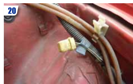
Coupez le contact. Puis localisez la prise jaune vers la tête d'amortisseur avant côté conducteur.
