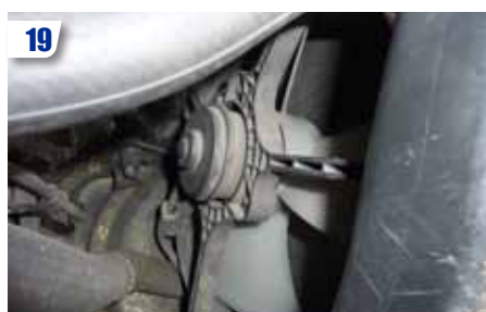
Faites le chauffer jusqu'au déclenchement du ventilateur de refroidissement moteur.
