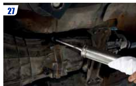
27 Remettre de l'huile dans la boîte de vitesse, soit par le niveau situé sur le côté (refermer lorsque l'huile dégouline), soit par le trou de levier de vitesses (verser le volume préconisé par le constructeur).
