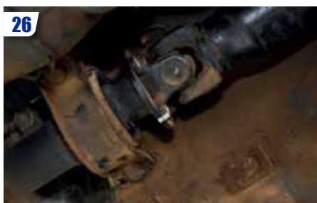
26 Remonter le support de boîte arrière, la mise à l'air, les connecteurs électriques, le récepteur d'embrayage et l'arbre de transmission.
