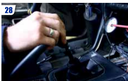
28 Remonter les derniers éléments : levier de vitesses (attention de bien positionner l'anneau élastique), soufflets, pommeau, etc.
