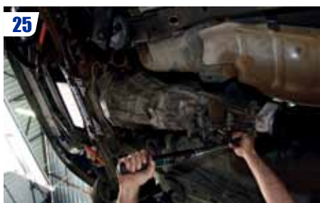
25 Positionner le démarreur en l'approchant dans l'axe de la boîte et serrer les vis de boîte au couple prescrit.
