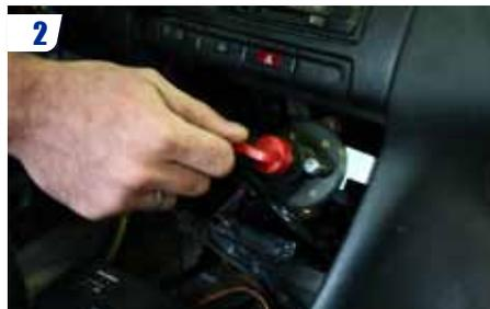
2 Débrancher la batterie (dans notre cas, nous avons simplement désenclenché le coupe-circuit).
