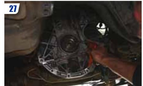
**Nettoyer et dégraisser les puits avec du nettoyant frein, puis les souffler pour les sécher.**
