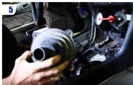
5 Dévisser la pièce qui maintient le soufflet de protection en caoutchouc puis déposer le soufflet.
