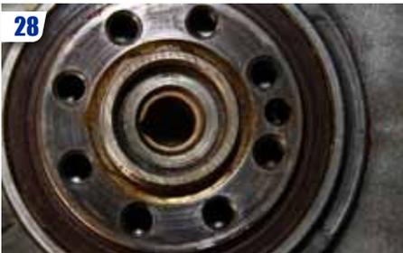
**A l'aide d'un Dremel ou d'une lame de scie à métaux, découper le palier bronze inséré dans le vilebrequin, puis le retirer en le déformant avec un petit tournevis plat (attention de ne pas endommager le vilebrequin).**
