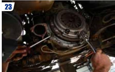
**Bloquer le volant moteur à l'aide d'un gros tournevis plat et desserrer progressivement les 9 vis de 12 qui maintiennent le plateau pression.**
