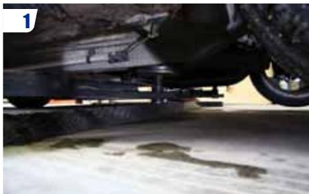
1 Ajuster les bras du pont élévateur, ou mettre la voiture sur les chandelles (frein à main baissé).
