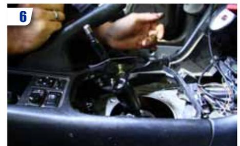
6 Retirer le second soufflet en caoutchouc. Ce dernier est maintenu à l'aide de colliers Rilsan ou métalliques. Prévoir de le remplacer car le caoutchouc est souvent en mauvais état.
