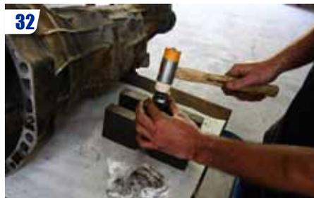
**Appuyer une douille sur le support de butée (son diamètre doit être inférieur à celui intérieur de la butée) et taper dessus avec un maillet.**
