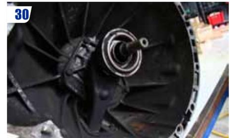
**Boîte de vitesses au sol, démonter la fourchette d'embrayage avec la butée. Retirer le cliclip et nettoyer le tout.**
