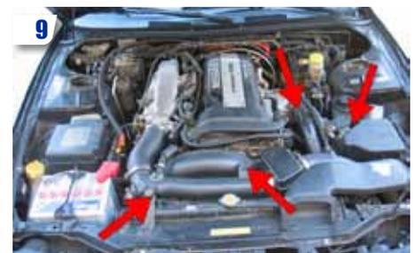
9 Pour les véhicules d'origine, dévisser les supports d'admission afin d'éviter qu'ils soient détériorés lorsque l'on va incliner le moteur.
