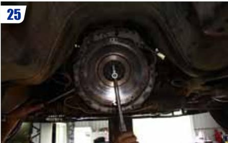
**Toujours en vous aidant d'un tournevis, desserrer les vis du volant moteur. Celles-ci sont généralement montées au frein-filet, prévoyez donc une rallonge !**
