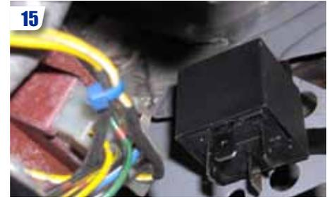
15 Trouver un emplacement pour le relais de la pompe additionnelle (ici proche du « main relay »).
