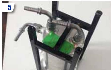
5 Si besoin, confectionner un support de réservoir tampon (dans notre cas, il sera le plus bas et le plus en arrière possible).
