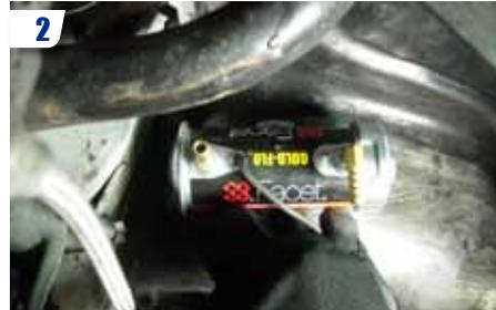
2 Pour un fonctionnement optimal, il n'est pas conseillé de mettre la pompe haut débit en position horizontale.
