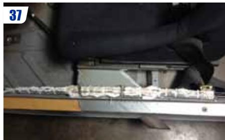
Une fois les essais concluants, finaliser le montage en sécurisant le faisceau électrique.
