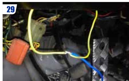
Confectionner un faisceau pour la commande du relais, et souder celui-ci au + d'alimentation d'origine de la pompe haute pression (ou à un + permanent via un interrupteur additionnel).
