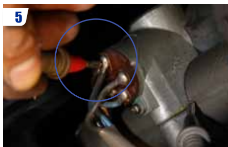
5 Mettez en contact le testeur « plus » du voltmètre avec l'une des bornes du neiman.
