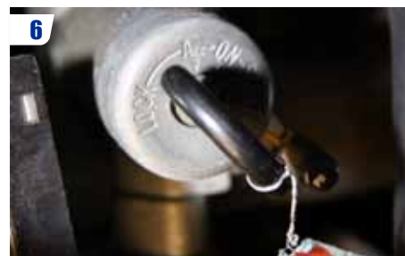
6 Insérez la clef et notez la valeur donnée par le voltmètre.
