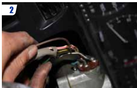
2 Repérez les gros fils connectés au neiman (et ne pas couper les fils !).
