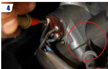
4 Mettez en contact le testeur « moins » du voltmètre à la colonne de direction.
