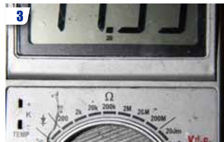
3 Réglez votre voltmètre sur V DC (mesure d'une tension en continu) et sélectionnez une valeur juste supérieure à la tension de batterie (ici, nous nous sommes donc positionnés sur 20 volts).
