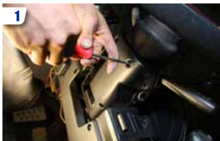
1 Démontez les protections autour de la colonne de direction (l'auto doit avoir le frein à main serré, et le levier de vitesses en position neutre).
