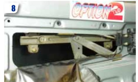
Remonter la manivelle (sans la reclipser pour autant) de manière à rendre l'accès aux vis de fixation de la vitre possible.
