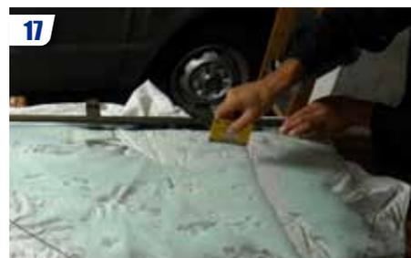
17 Le liquide vous permet de positionner avec précision le film. Chasser le liquide de l'intérieur à l'extérieur à l'aide d'une carte en plastique.
