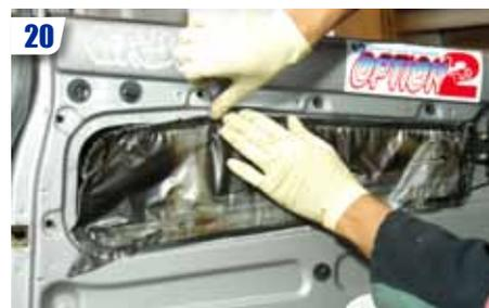
20 Procéder au remontage en suivant l'ordre inverse de la dépose. Recoller le film, et s'assurer du bon fonctionnement du mécanisme avant le remontage complet.
