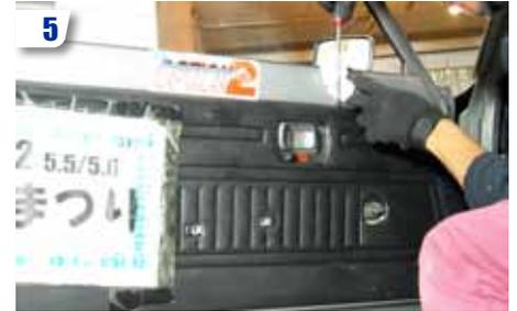
Une fois la poignée, les ornements en plastique et la manivelle déposés, dégrafer la garniture de porte à l'aide d'un tournevis plat.
