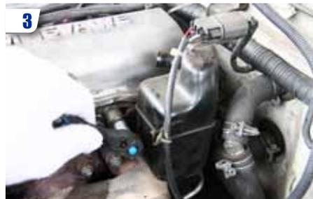
3 Dans le cas d'un moteur à distribution par chaîne équipé d'un séparateur d'huile (et seulement dans ce cas précis), démonter le séparateur et ses durites.
