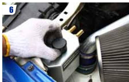
6 Définir l'endroit où le récupérateur d'huile (le décanneur donc) sera installé : loin d'une source de chaleur et facile d'accès. Attention au chemin des durites et à l'orientation du récupérateur.
