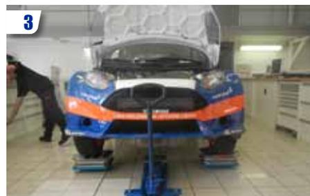
3 Installer des balances sous chaque roue. Ces balances permettront de mesurer le poids supporté par chaque roue, leur alignement et le carrossage.
