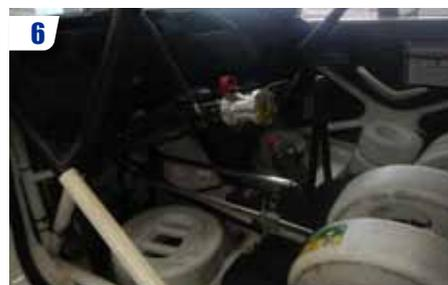
6 Installer un bloc volant et un bloc frein afin de garder les roues droites et de ne pas modifier le paramètre freinage.
