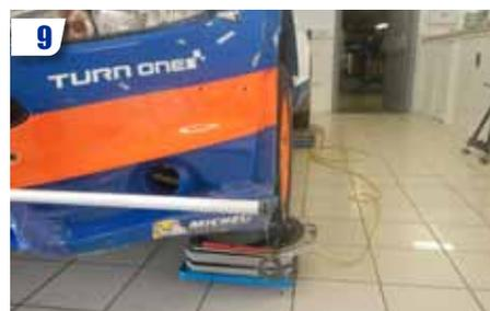
9 Installer des barres de pince à l'avant et à l'arrière du véhicule pour vérifier l'alignement des roues. Pour cela, vous relier deux fils de l'avant vers l'arrière du véhicule grâce aux barres de pince. Méthode archaïque mais la plus efficace !
