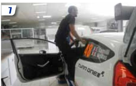
7 Remettre en condition les suspensions de la voiture. A force d'être mise sur cric, les suspensions de la voiture se détendent, il est important de les comprimer avant de poursuivre. Pour cela rien de plus simple, secouez la voiture !
