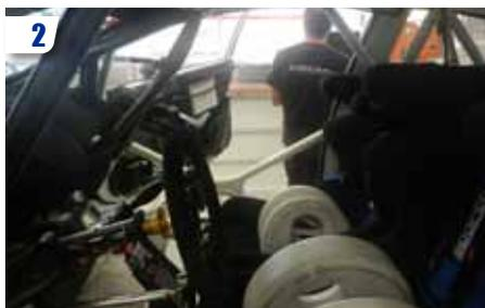
2 Reproduire l'équivalent des poids pilote/copilote. Utiliser des poids qui vous permettront de répartir le poids présent dans le véhicule au moment du set up.
