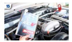
Une fois le montage terminé, remonter correctement tous les éléments déposés et verser l'huile neuve dans le moteur. En fonction de la capacité de votre radiateur, il faudra rajouter entre 0,5 et 1,5 litres de lubrifiant en plus de la capacité normale.
