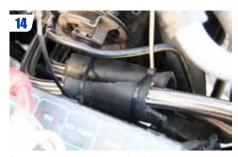
Connecter les durites et les protéger à l'aide de durites en caoutchouc à proximité de tôles coupantes ou de zones de frottement. Les fixer pour éviter qu'elles ne viennent en contact avec des pièces en mouvement.
