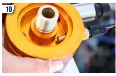
Installer les sondes sur la platine côté filtre. Attention : s'assurer que l'extrémité de la sonde température ne vienne pas en contact avec l'intérieur de la plaque.
