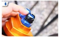
Installer la plaque côté moteur. Vous pouvez utiliser du scotch pour protéger les filets lors de l'installation.
