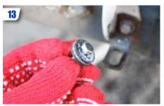
Le radiateur doit être monté sur silentblocs pour éviter que les vibrations ou les petits chocs ne l'endommagent.
