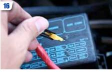
Déconnecter le fusible de pompe à essence. Nous vous conseillons pour faciliter l'opération suivante de retirer également les bougies. Cela évitera à votre batterie de se vider trop vite ou que le moteur démarre avec la pression d'essence résiduelle.
