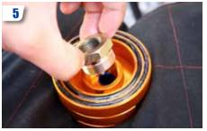
Monter l'adaptateur sur la plaque moteur qui correspond au pas de vis de bloc. Monter au préalable la bague seule sur le moteur pour être sûr qu'elle corresponde parfaitement. Serrer l'adaptateur en maintenant la plaque dans un étau (protéger l'alu avec un chiffon).
