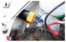
Définir un emplacement pour la platine. Penser à faciliter le démontage du filtre lors de la vidange (la photo est trompeuse, mais l'espace est ici suffisant), à éviter d'avoir des coudes serrés avec les durites (obstacle à proximité des raccords).
