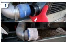
Débrancher la batterie, vidanger la voiture, déposer le filtre usagé et démonter les éléments qui pourront gêner l'installation du radiateur. Attention à déboucher le piping d'admission, les durites d'air, etc.
