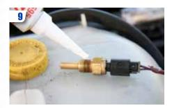
Badigeonner les filets des sondes de joint silicone.
