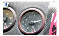
Remettre le fusible en place, vérifier le niveau d'huile (rajouter si nécessaire) et démarrer le moteur. Surveiller les éventuelles fuites notamment au niveau des raccords et contrôler que la pression monte correctement.
