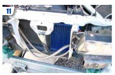
Définir un emplacement et une orientation pour le radiateur. Penser à protéger les ailettes de chaque côté à l'aide de carton et à boucher les orifices pour éviter que des poussières ou des petits objets ne pénètrent à l'intérieur.
