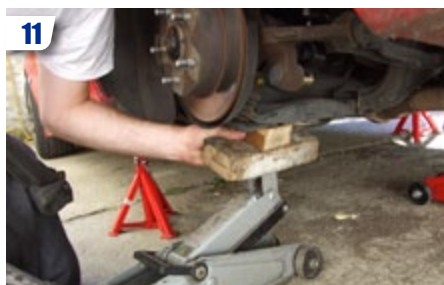
11 Si vous avez du mal à remonter le bras et la fusée, placez un cric sous l'ensemble et remontez-le doucement jusqu'à ce que l'axe tombe en face de l'insert.
