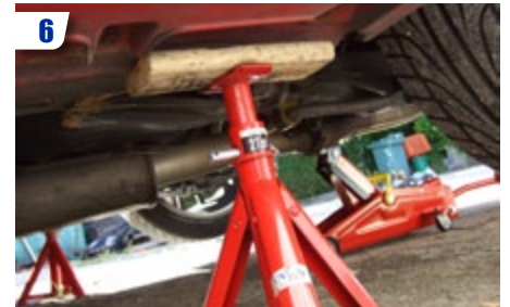
6 Mettre des chandelles et enlever les roues.
