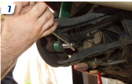
7 Dévisser la vis en bas des suspensions.
