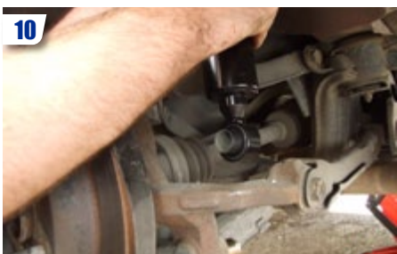
10 Enquiller la nouvelle suspension pendant qu'une personne approche les deux vis du dessus afin qu'elle ne tombe pas.
