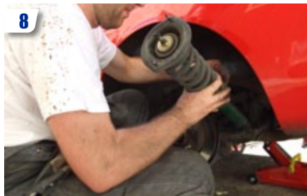
8 Pendant qu'une personne tient l'amortisseur, enlever complètement les vis du dessus (attention, si personne ne retient la suspension, elle va tomber !) et déposer la suspension.
