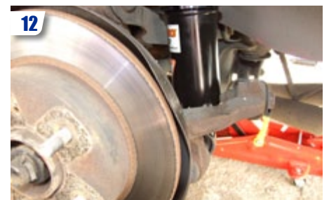
12 Enfiler le bas de l'amortisseur dans l'axe. Faites attention au sens de l'insert du bas de l'amortisseur (partie longue vers l'extérieur de la voiture, opposée donc à l'écrou).
