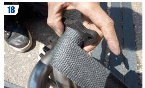
Commencer par la flange, et enrouler assez fermement la bande autour du premier tube. Comme pour le montage à blanc, bien recouvrir l'enroulement précédent d'au moins la moitié de sa largeur.
