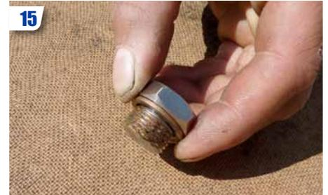
Graisser les filets du bouchon de la sonde Lambda et bien le serrer (si vous avez une sonde, graisser le filet de celle-ci).
