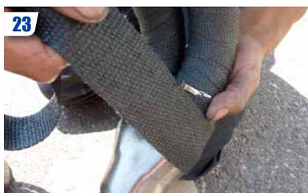
Pour la seconde partie du collecteur, enrouler la bande en utilisant la même technique que précédemment. Attention de ne pas bander la partie coulissante dans la partie haute du collecteur !
