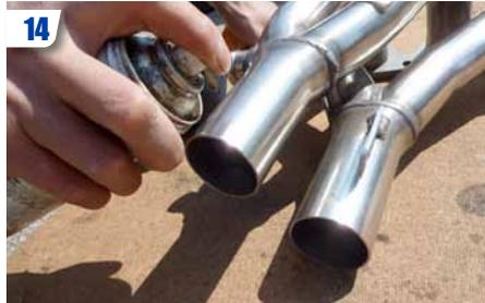
Préparer le collecteur, bien graisser les parties qui coulisent entre elles à l'aide de graisse « cuivre » (bonne tenue aux hautes températures) ainsi que le reste de la boulonnerie.
