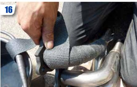
Déterminer la longueur de la bande à utiliser pour un tube en faisant un premier montage grossier (entre la culasse et la liaison en « 4-2 »). Prendre soin de bien chevaucher l'enroulement précédent d'au moins la moitié de sa largeur.
