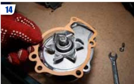
14 Pour l'étanchéité, première solution : monter le joint papier (si fourni avec la pompe).
