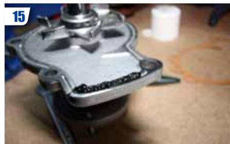
15 Deuxième solution : réaliser un cordon avec de la pâte à joint prévue pour cet usage.
