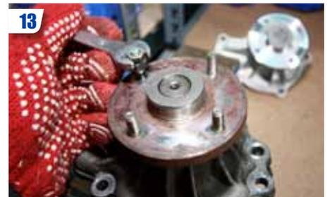
13 Récupérer sur l'ancienne pompe les vis de fixation du ventilateur, à l'aide d'un écrou et d'un contre-écrou.
