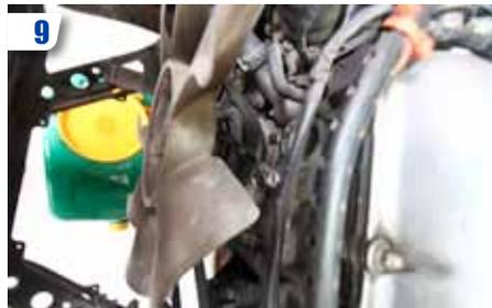
9 A l'aide d'une clé plate, démontez le ventilateur d'origine.
