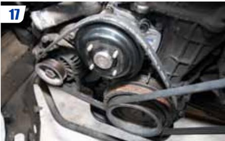
17 Replacer la courroie et la retendre via la vis de réglage, et resserrer l'alternateur.
