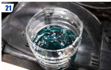
21 Démarrer l'auto et rajuster le niveau de la bouteille pour chasser les bulles d'air du circuit.
