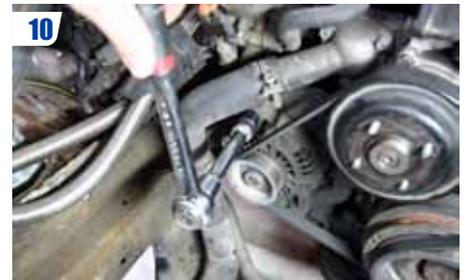
10 A l'aide d'un cliquet, débloquer toute la boulonnerie maintenant l'alternateur, puis détendre la courroie à l'aide de la vis prévue à cet effet.
