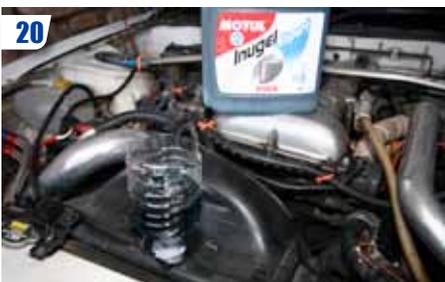
20 Remplir le radiateur par la bouteille jusqu'à ce que le niveau ne descende plus.
