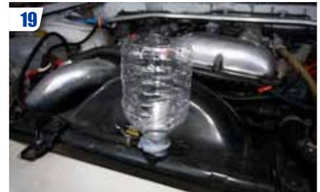
19 La fixer avec du scotch épais sur le bouchon de remplissage du radiateur.
