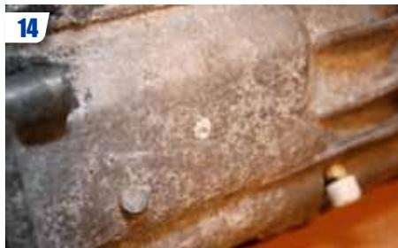
**14** Repérer un emplacement dégagé. Percer un pré-trou avec une petite mèche, sans traverser la paroi. Souffler les copeaux régulièrement.
