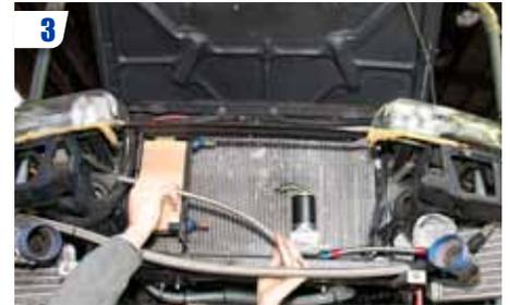
3 Repérer les longueurs nécessaires et laissez un peu de marge. Veiller à ce que les durites soient loin de l'échappement, et à distance raisonnable des éléments en mouvement.
