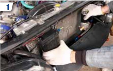
1 Réfléchir au positionnement des différents éléments (attention au sens de la pompe et du filtre) et au passage de durites. Si nécessaire, faire un montage « à blanc ». Dans notre cas, il y avait de la place devant la voiture, mais le radiateur peut tout aussi bien se retrouver à l'arrière sous le châssis.
