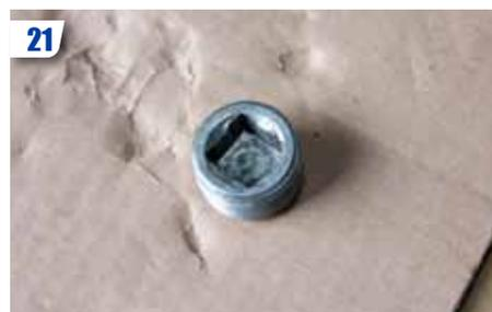
**21** Mettre le bouchon ou boucher le trou de remplissage pour éviter que l'huile ne gicle.
