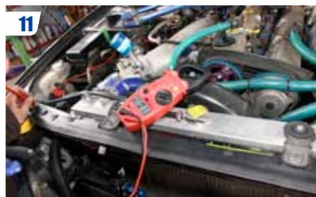
11 Positionner l'interrupteur, le relais et le fusible dans l'habitacle. S'assurer que les points de masse pris sur le châssis sont bien reliés à la masse de la batterie (test au voltmètre).
