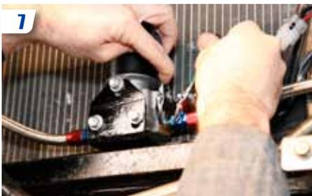
7 Puis, lors du « verrouillage », maintenir de l'autre côté, pour ne pas forcer sur l'élément. Les embouts de radiateur, notamment, sont très fragiles.
