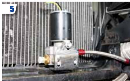
5 Créer des supports rigides pour la pompe qui est lourde (attention au sens de circulation). Vérifier le serrage des éléments de la pompe. Il est possible que le fabricant n'ait pas vissé complètement les embouts. Un petit coup de peinture pour protéger de la rouille n'est pas un luxe.
