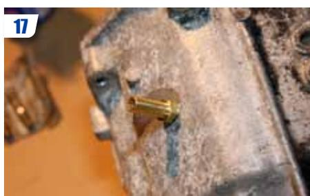
**17** Nettoyer et installer l'embout. Attention de ne pas trop forcer. L'alu, c'est fragile et la paroi n'est pas épaisse (3 ou 4mm). Utiliser du ruban Teflon pour éviter toute fuite.
