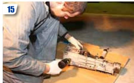
**15** Finir le trou à l'aide d'une mèche de diamètre adéquat qui permettra de tarauder dans de bonnes conditions. Ne surtout pas forcer à la fin du trou, afin de ne pas rentrer entièrement la mèche dans la boîte et endommager des éléments internes. Attention de bien percer droit !
