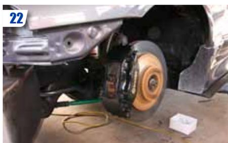
**22** Démarrer le moteur et faire tourner les roues dans le vide pour faire monter la température d'huile de boîte. Si l'huile est froide, la pompe risque de casser. La voiture doit être parfaitement stable pour cette opération.
