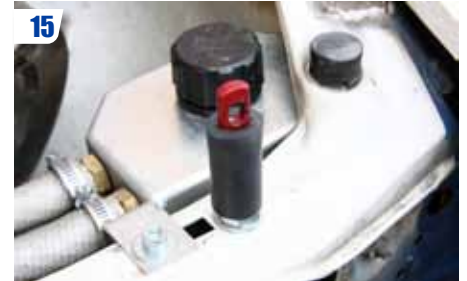
Emmancher sur la tige le bout de durite qui servira d'amortisseur anti-vibration. Le raccourcir si besoin. Capot fermé, les attaches doivent se reposer sur le caoutchouc.
