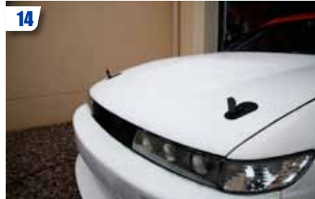
Régler la hauteur des tiges pour que le capot ferme correctement.
