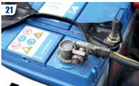
Rebrancher la batterie et mettre le contact sans démarrer le moteur pour vérifier si les manos sont bien alimentés. Allumer les feux pour vérifier l'illumination.
