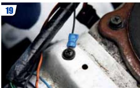
Fixer la cosse à œillet sur le point de masse du châssis.
