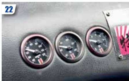
Démarrer le moteur et vérifier que les manos fonctionnent correctement (montée en pression, en température, etc.).
