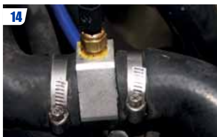
14 Emmancher les deux morceaux de tuyau sur le « T » sans serrer les colliers.
