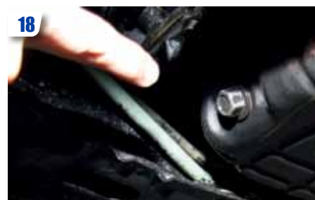
18 Démarrer le moteur et respecter les procédures de remise en route pour l'huile et le liquide de refroidissement (repérage des fuites, niveaux, évacuation des bulles d'air, etc.).
