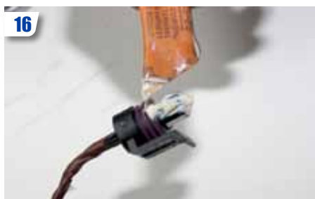
16 Graisser le connecteur de sonde et brancher le câble.
