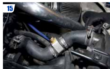
15 Installer l'ensemble entre le moteur et le radiateur. Faire varier l'orientation des différents éléments si besoin. Faire attention que les durites ne soient pas pliées ou pincées. Serrer les colliers.
