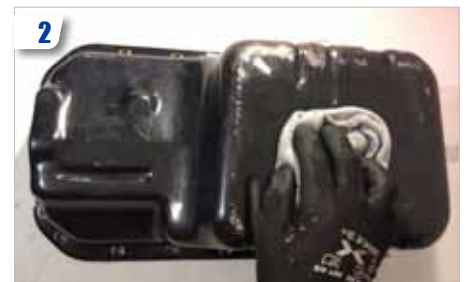
2 Commencer par dégraisser plus que de raison la pièce à traiter. Pour enlever le plus gros, nous avons eu recours à de l'essence F, et à du diluant cellulosique pour la finition.
