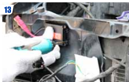
13 Installer les ballasts. Sur une surface plane et parfaitement dégraissée, un scotch double face (épais) de qualité marche à merveille !
