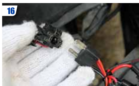
16 Connecter les cosses d'ampoules au faisceau d'origine de la voiture (sur la prise normalement connectée aux ampoules halogènes).
