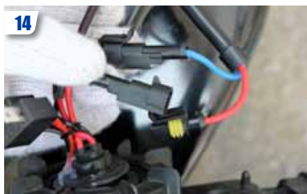
14 Remonter les phares, brancher les câbles et les sécuriser pour éviter qu'ils ne puissent se balader n'importe où.
