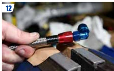
12 Vérifier le repère de Scotch. Si la durite a reculé de plus de 2mm, recommencer la procédure. Une fois que la durite est équipée des deux côtés, bien la nettoyer et la souffler.
