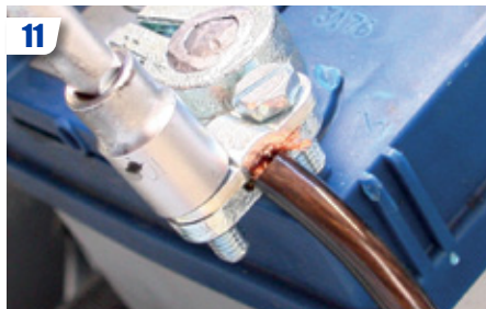
11 Installer un œillet d'un côté du câble (fixation châssis). De l'autre côté, la tresse nue peut être pincée par la cosse directement (cela dépend de votre modèle de cosse).
