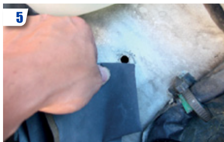
5 Trouver un point de fixation (tôle du châssis) à proximité de votre câble de masse, décaper la peinture au papier de verre et fixer le câble de masse à la tôle du châssis (et non au moteur).
