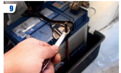
9 Fixer le bac au châssis, installer la batterie et s'assurer que celle-ci soit solidement arrimée.
