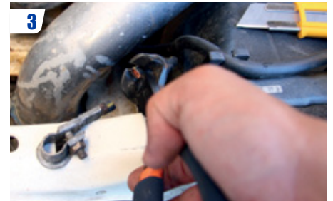
3 Couper le câble de masse à ras la cosse négative et le dénuder sur environ 7 mm.
