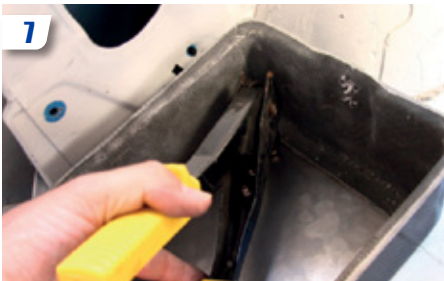
7 Nous avons choisi ici de renforcer la base de notre bac à l'aide d'une plaque en alu et de réutiliser les tiges d'origine pour maintenir la batterie dans le bac. Selon la discipline et la catégorie dans laquelle vous courez, vous devrez impérativement respecter le règlement.
