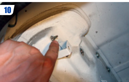
10 Fabriquer un câble de masse qui reliera la borne négative de la batterie à une tôle du châssis. Comme précédemment, décaper la peinture pour mettre la tôle à nu et assurer un contact métal-métal parfait.
