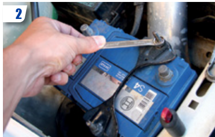
2 Démontez le support de batterie puis déposez la batterie.
