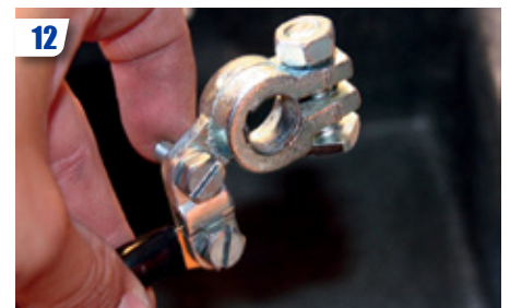
12 Dénuder l'extrémité du câble d'alimentation, et comme précédemment, pincer la tresse dans la cosse positive. Vous pouvez en outre installer un œillet (voir photo) et le fixer sur la cosse. Ne pas encore connecter à la batterie.
